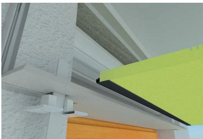
**5. Posizionamento AGP 5038 e AGP 5045:** prima di montare il cassonetto dobbiamo assicurarci di chiudere lo spazio tra avvolgibile e serramento ed isolare la parte inferiore del vano cassonetto sopra il serramento. Applicare l'apposito pannello AGP 5038 con inserito lo spazzolino posizionandolo sopra il serramento in appoggio al telo. Eliminare la parte eccedente di AGP 5038 che sporge oltre la barra di contenimento.
