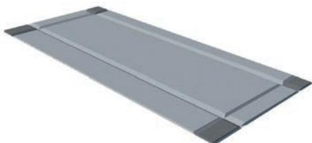
**2. Eliminare gli angoli:** dopo aver realizzato la fresata sul lato mancante inizia a prendere forma la struttura portante di CassoMuro e si prosegue eliminando gli angoli del pannello sempre con un cutter e verificando che essi combacino perfettamente. Eventuali imperfezioni del taglio e della fresata possono essere recuperate con una leggera carteggiatura con carta abrasiva grana 120.
