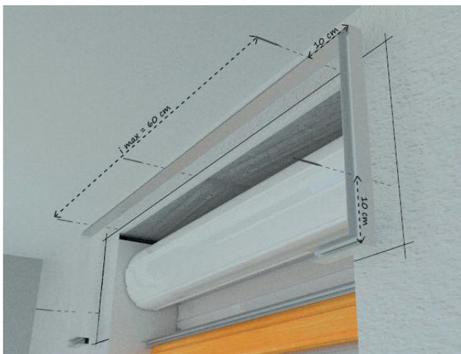
**4. Fissaggio della cornice di contenimento a muro:** appoggiare il cassonetto alla muratura con applicato la cornice di contenimento costruita con AGP 5068. Segnare sul muro la posizione del telaio dopo aver messo in bolla il cassonetto.
