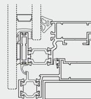
Sirio 50N è stata pensata per dare la possibilità di creare nastri di finestre utilizzando i profili facciata Sirio, di bellezza unica. Il sistema prevede un giunto di dilatazione realizzato con profili montanti che garantiscono continuità al modulo e tenuta ermetica. Denominatore comune di queste soluzioni è la garanzia di tenuta sia agli agenti atmosferici (aria, acqua, vento) che di isolamento termico ed acustico.
