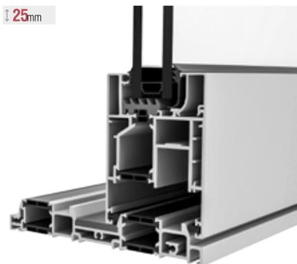
**ARMONIA-S SOGLIA RIBASSATA.** Soglia con altezza 25mm. A norma per l'abbattimento delle barriere architettoniche. Binario in acciaio inox.
